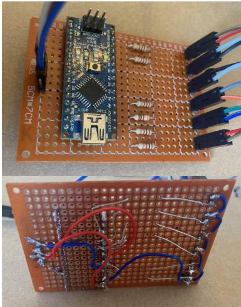
In der auf dem Bild abgebildeten Version der Schaltung ist noch ein Fehler enthalten, da wir vergessen haben die Fotoresistoren in einer Voltage Divider Schaltung mit den Arduinos zu verbinden.
