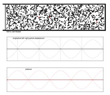
Dieser Druckgradient wiederum erzeugt eine Kraftwirkung, welche immer von Arealen hoher Druckänderung (Wellenbauch) zu Arealen geringerer Druckänderung (Knotenpunkt) verläuft und auf Objekte im akustischen Feld - auch entgegen der Schwerkraft - einwirkt. Die Knotenpunkte bilden damit sogenannte "akustische Fallen", aus denen sich die Objekte nur durch Zuführung von Energie wieder "befreien" können.
