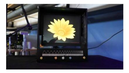
Nach Zuschnitt haben haben wir die Seitenwände durch den Lasercutter verziert. Die per Hand gezeichneten Blumen und Insekten wurden als Vektoren gespeichert. Nach der Verzierung haben wir den Rahmen geleimt und trocknen lassen. Im Anschluss wurden die Taster mit dem Rahmen verbunden und verkabelt.
