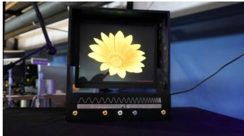
Nach Zuschnitt haben haben wir die Seitenwände durch den Lasercutter verziert. Die per Hand gezeichneten Blumen und Insekten wurden als Vektoren gespeichert. Nach der Verzierung haben wir den Rahmen geleimt und trocknen lassen. Im Anschluss wurden die Taster mit dem Rahmen verbunden und verkabelt.
