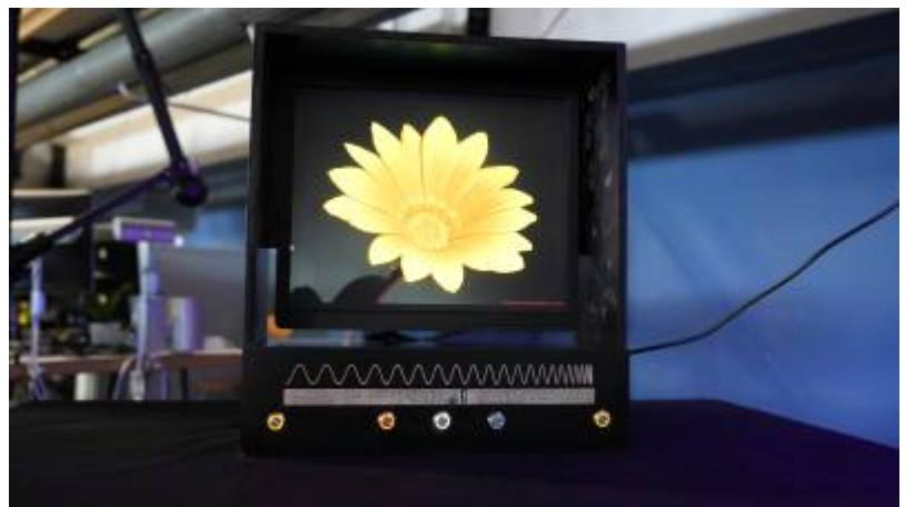
Nach Zuschnitt haben haben wir die Seitenwände durch den Lasercutter versehen. Die von Jana per Hand gezeichneten Blumen und Insekten wurden als Vektoren gespeichert. Nach der Verzierung haben wir den Rahmen geleimt und trocknen lassen. Im Anschluss wurden die Taster mit dem Rahmen verbunden und verkabelt.
