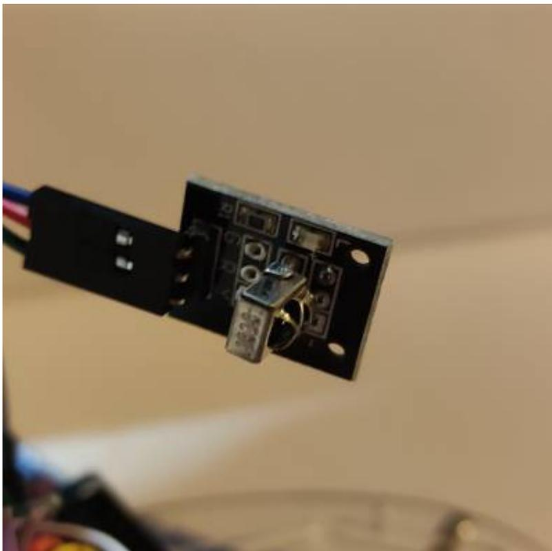
Mit dem IR - Receiver und der Library IRremote lesen wir Anfragen, der Fernbedienung aus. Bei dem Erhalten vom Signal des Power-Buttons wird das Fahrzeug an und aus geschaltet.
