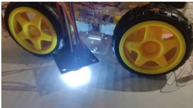
Der Farbsensor besitzt drei Fotodioden (Rot, Grün und Blau) Mit dem Arduino werden die Werte für die drei Fotodioden ausgelesen.
