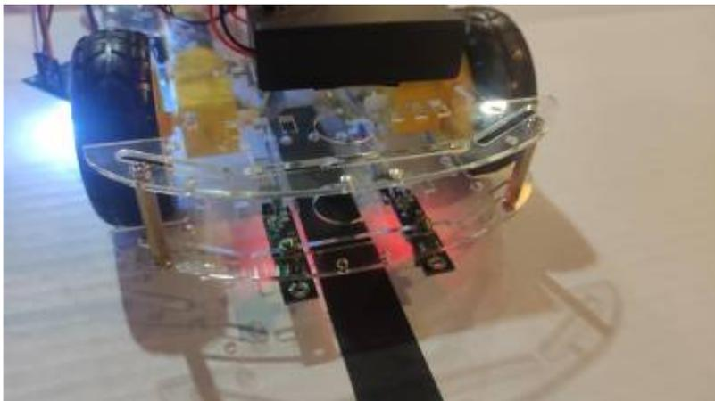
Die Infrarotsensoren überprüfen, ob die Fläche auf die Sie zeigen Licht reflektiert. Absorbiert eine Fläche das Licht (in unserem Fall bei einem schwarzen Klebeband) sendet der Sensor über die digitalen Pins des Arduinos den Wert 1 an den Arduino. Andernfalls wird bei einer Fläche, welche das Licht reflektiert, der Wert 0 an den Arduino gesendet.
