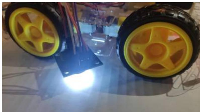
Der Farbsensor besitzt drei Fotodioden (Rot, Grün und Blau). Mit dem Arduino werden die Werte für die drei Fotodioden ausgelesen.
