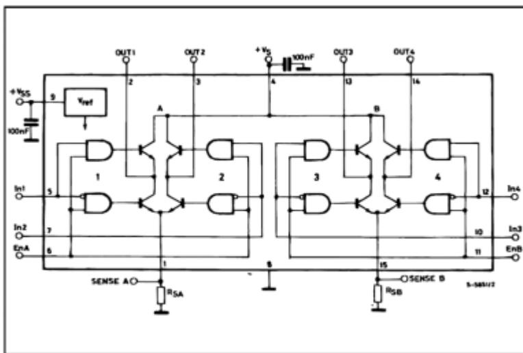
Die Motoren sollen in sich in beide Richtungen drehen können, dafür habe wir eine bidirektionale Konfiguration ausgewählt. Jeder Kanal hat jeweils zwei Ausgänge die durch zwei Eingänge gesteuert werden. Ein Enable Pin sorgt für das Ein- und Ausschalten eines Kanals. Die zwei Ausgänge eines Kanals werden an den DC Motor angeschlossen. Um den Motor drehen zu lassen, muss einer der
