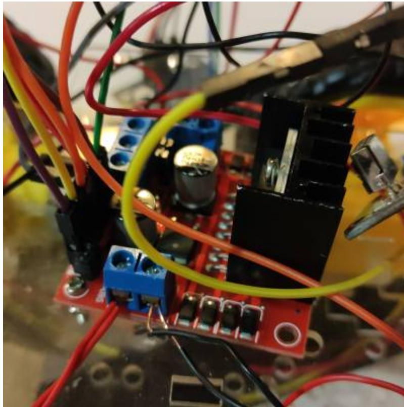
Um das Motor mit dem Mikrocontroller zu steuern, wird ein Motortreiber zwischen Motor und Mikrocontroller verwendet, weil die GPIO von Arduino nur maximal 40 mA liefern können. Hier wird ein integrierter Motortreiber L298N ausgewählt. Der Motortreiber besitzt 2 H-Brücken und eine Treiberschaltung, die gleichzeitig 2 bidirektionale Kanäle oder 4 unidirektionale Kanäle bietet.
