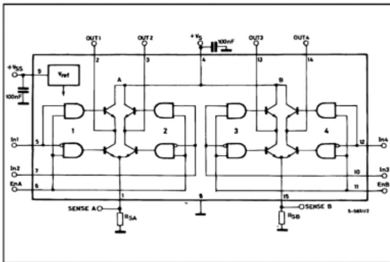
Die Motoren sollen sich in beide Richtungen drehen können, dafür habe wir eine bidirektionale Konfiguration ausgewählt. Jeder Kanal hat jeweils zwei Ausgänge die durch zwei Eingänge gesteuert werden. Ein Enable Pin sorgt für das Ein- und Ausschalten eines Kanals. Die zwei Ausgänge eines Kanals werden an den DC Motor angeschlossen. Um den Motor drehen zu lassen, muss einer der
