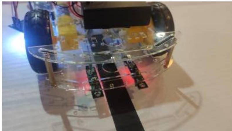
Die Infrarotsensoren überprüfen, ob die Fläche auf die Sie zeigen Licht reflektiert. Absorbiert eine Fläche das Licht (in unserem Fall bei einem schwarzen Klebeband) sendet der Sensor über die digitalen Pins des Arduinos den Wert 1 an den Arduino. Andernfalls wird bei einer Fläche, welche das Licht reflektiert, der Wert 0 an den Arduino gesendet.
