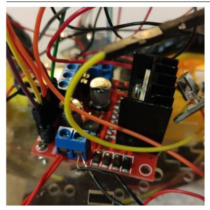
Um das Motor mit dem Mikrocontroller zu steuern, wird ein Motortreiber zwischen Motor und Mikrocontroller verwendet, weil die GPIO von Arduino nur maximal 40 mA liefern können. Hier wird ein integrierter Motortreiber L298N ausgewählt. Der Motortreiber besitzt 2 H-Brücken und eine Treiberschaltung, die gleichzeitig 2 bidirektionalen Kanäle oder 4 unidirektionalen Kanäle bietet.
