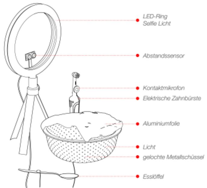
Erstens wurden LED-Ringlights verwendet. Abstandssensoren in Verbindung mit Arduino Nanos konnten so programmiert werden, dass sie ab einer bestimmten Entfernung ein binäres Signal an einem Transistor leiteten, der die Stromversorgung des LED-Ringlights kontrollierte. Es wurde demnach dauerhaft ein *Aus*-Signal an den Transistor gesendet und die Lampe blieb dunkel, bis die Performer\*innen eine gewisse Distanzgrenze unterschritten. Dann wurde ein *Ein*-Signal gesendet und die Lampe leuchtete.
