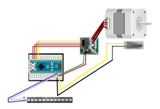
Abbildung 6: Arduino- und Schrittmotor-Verschaltung
