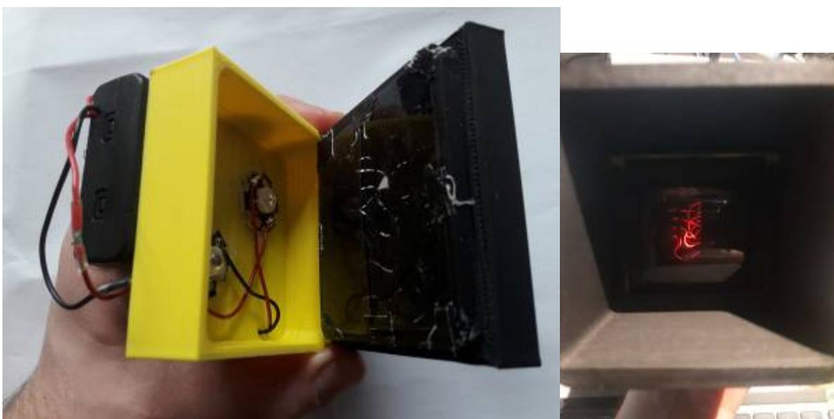
Dabei kann der Aufbau so erweitert werden, dass die LEDs nur dann angehen, wenn alle Scheiben eingesetzt sind. Das kann über Reed Schalter geschehen, die an der Seite des gesamten Aufbaus
