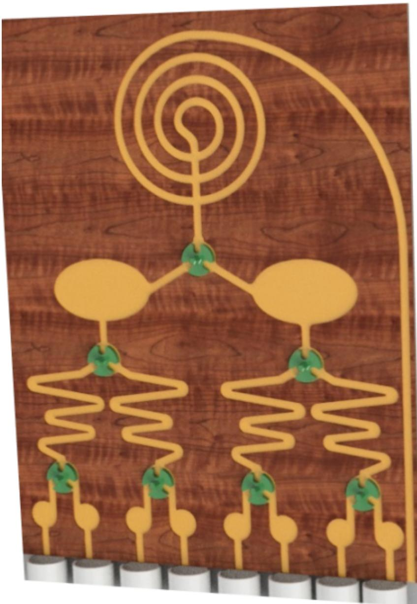
Bei der ersten Iteration der Maschine haben wir uns für eine 2-dimensionale Murmelbahn mit manipulierbarem Pfad entschieden. Der Prototyp wird zunächst aus maximal 3 Entscheidungsebenen bestehen. Die Vorderseite der Murmelbahn wird aus einer transparenten
