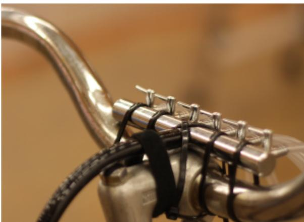
Für die Schläuche wurden zusätzlich Halterungen und Düsen 3D gedruckt. Mithilfe der Halterungen können die Luftströme durch den Schlauch im richtigen Winkel und mit der richtigen Entfernung am
