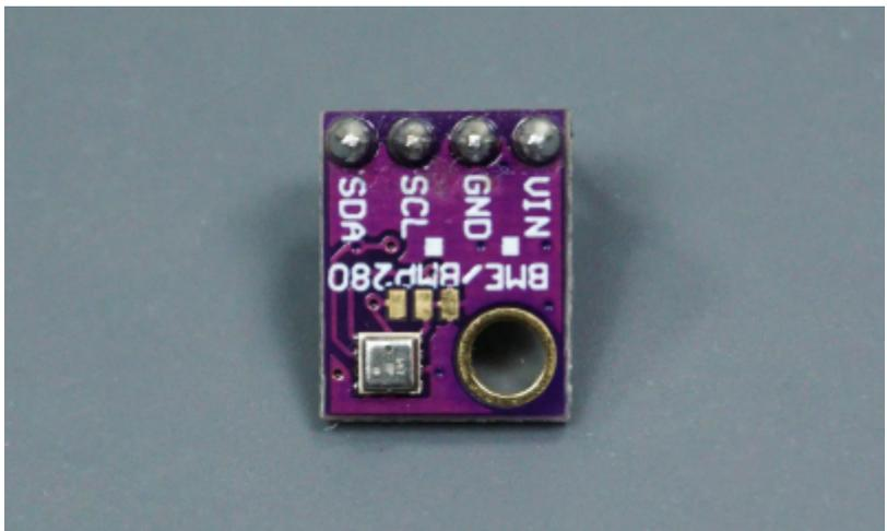
Der BME/BMP280 Tempraturesensor ist ein Vollständiges Modul, das die Temperatur, die Luftfeuchtigkeit und den Lufdruck misst und die gemessenen Daten anschließend über eine I<sup>2</sup>C Schnittstelle ausgibt. Durch die Ausgabe über die I<sup>2</sup>C Schnittstelle können die Daten sehr einfach mit dem Arduino ausgelesen und verarbeitet werden. Zusätzlich gibt es eine Bibliothek, die es erlaubt mit einem Funktionsaufruf die Daten auszulesen.
