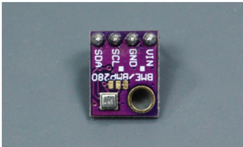
Der BME/BMP280 Tempratursensor ist ein Vollständiges Modul, das die Temperatur, die Luftfeuchtigkeit und den Lufdruck misst und die gemessenen Daten anschließend über eine [I<sup>2</sup>C](#) Schnittstelle ausgibt. Durch die Ausgabe über die [I<sup>2</sup>C](#) Schnittstelle können die Daten sehr einfach mit dem Arduino ausgelesen und verarbeitet werden. Zusätzlich gibt es eine [Bibliothek](#), die es erlaubt mit einem Funktionsaufruf die Daten auszulesen.
