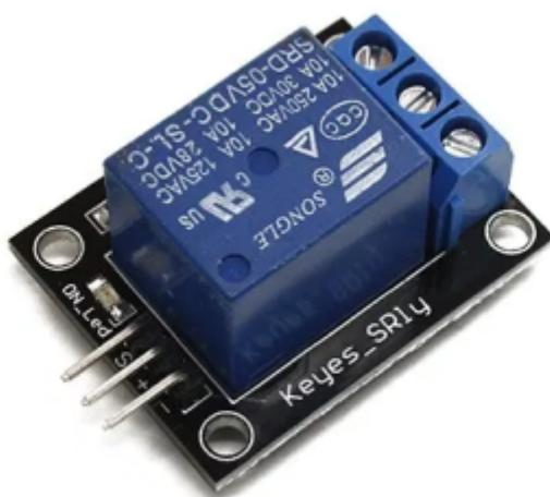
Das Relais-Modul wird benötigt, damit der Arduino Höhere Spannungen und Höhere Ströme mit einem sehr kleinen Steuerungssignal steuern kann. Wenn beispielsweise eine Handelsübliche LED-
