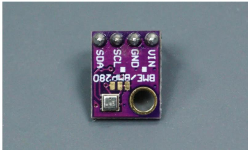
Der BME/BMP280 Temperatursensor ist ein Vollständiges Modul, das die Temperatur, die Luftfeuchtigkeit und den Lufdruck misst und die gemessenen Daten anschließend über eine [I<sup>2</sup>C](#) Schnittstelle ausgibt. Durch die Ausgabe über die [I<sup>2</sup>C](#) Schnittstelle können die Daten sehr einfach mit dem Arduino ausgelesen und verarbeitet werden. Zusätzlich gibt es eine [Bibliothek](#), die es erlaubt mit einem Funktionsaufruf die Daten auszulesen.
