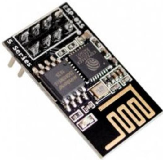
Der ESP01-S ist auch ein Mikrocontroller, der auch, ähnlich wie der Arduino, programmiert werden kann, um Steuerungsaufgaben zu übernehmen.
