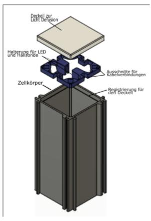
ist mit einem ebenfalls 3D-gedruckten Deckel verschlossen, in dem Aussparungen für die Stromverbindung (und Taktgebung) sind.
